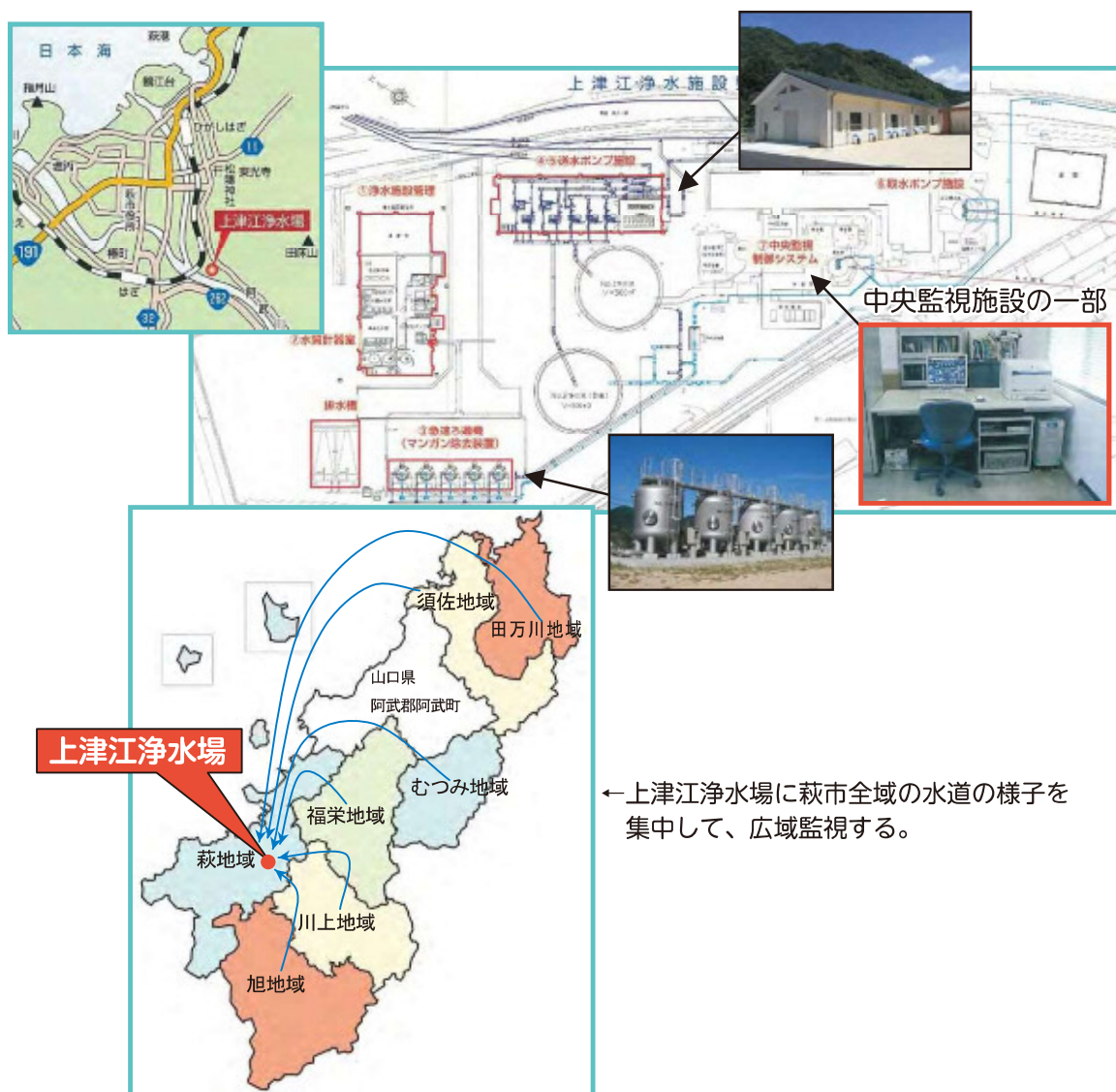
図2-7 上津江浄水場 広域監視イメージ
