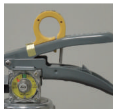
× レバー支えの脱落
