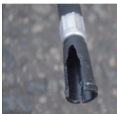
× ノズルの破損
