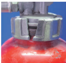
× キャップの破損
