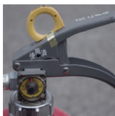
× 表示装置の脱落
