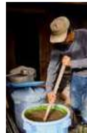
鉄分は萩焼に黒い斑点を生じるため灰を水に浸けて脱鉄し、アクも除く
