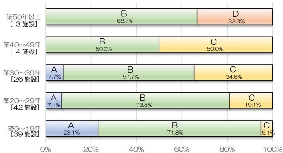
図6 外壁の築年数別劣化状況
