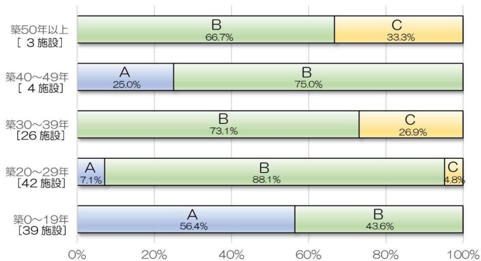
図7 内部仕上の築年数別劣化状況
