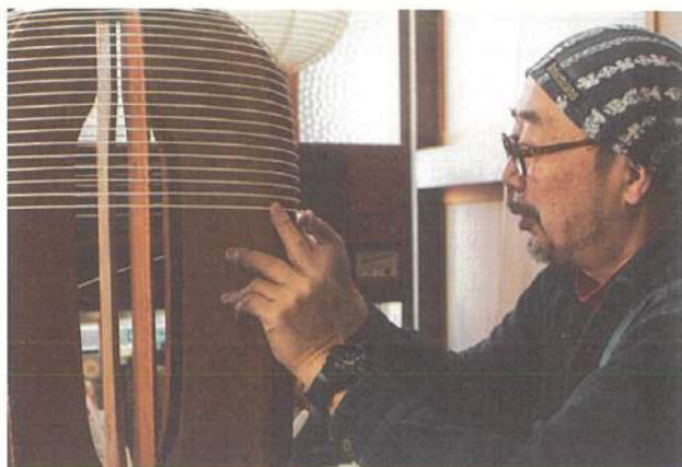
提灯の肝となるひごが乱れることのないよう、集中して巻く
