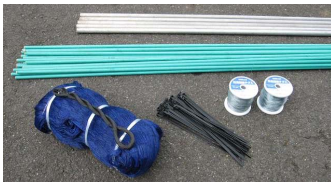
写真1 奥から直管パイプと弾性ポール 手前は左から防鳥網、結束バンド、テグス
