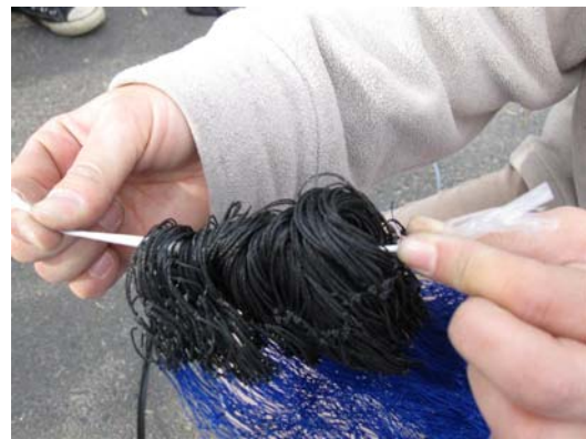
写真 12 網の端を束ねたひもを抜き取らずにほどこき、張り糸を通す
