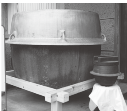
高さ1.5m、釜の口直径1.4m、胴周り5mの酒造釜
