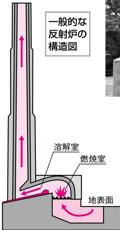
**反射炉の構造と特徴**
